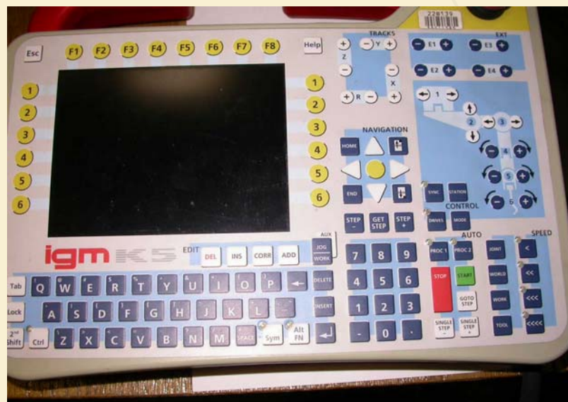
IGM-KUKA hegesztőrobot programozó-konzolja
