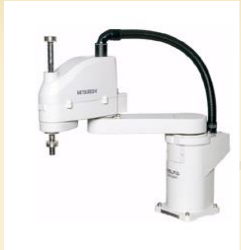
SCARA típusú robot Mitsubishi
