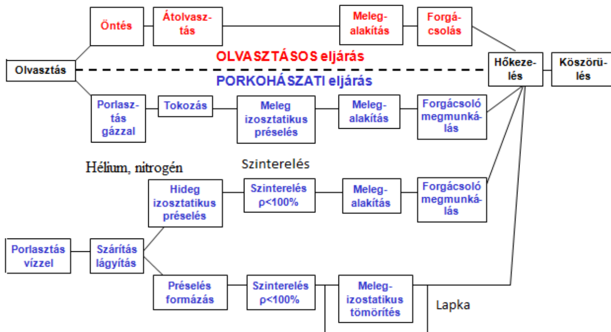
1.26. ábra A gyorsacél előállítási technológiái [4]
