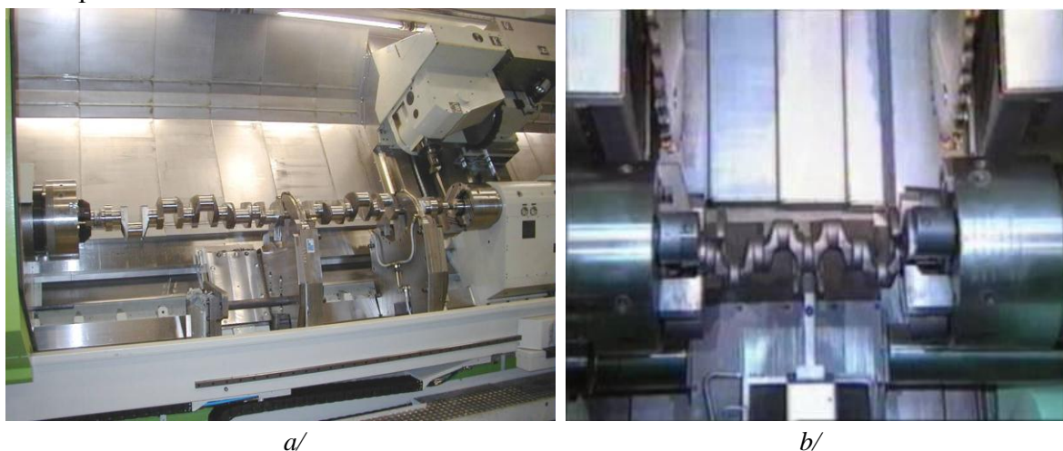
2.31. ábra Forgattyús tengely esztergálása a/ hagyományos szerszámokkal [Niles] b/ különleges tárcsa alakú szerszámmal [Sandvik]
