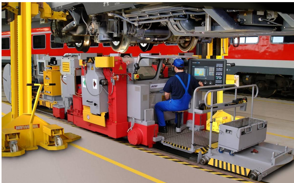
2.33. ábra Vasúti kerékpár felújítása kiszerelés nélkül [Hegenscheidt MFD]
