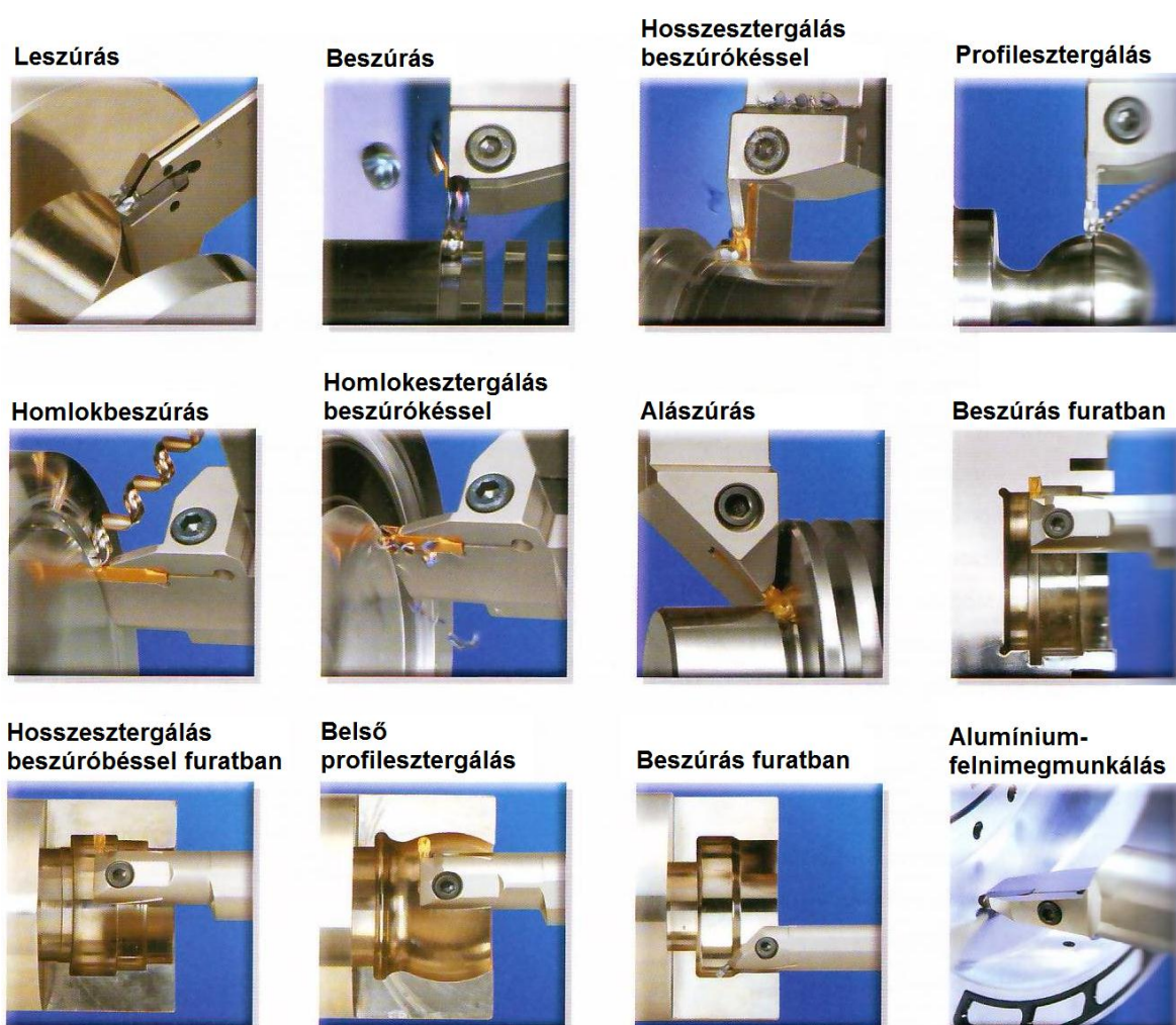
2.7. ábra Beszúrás és leszúrás módszerei [Taegutec] [23]
