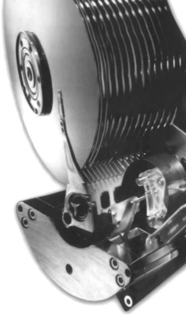
10. ábra A mágneslemez mechanikai része
